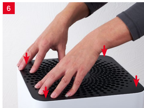
用力向下按压，使盖子重新扣回原位。
